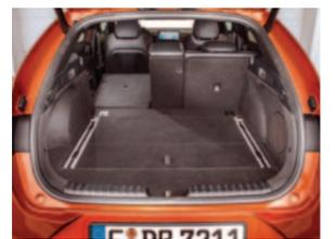
**Praktisches Ladeabteil** mit Schienensystem zur Ladungssicherung.
