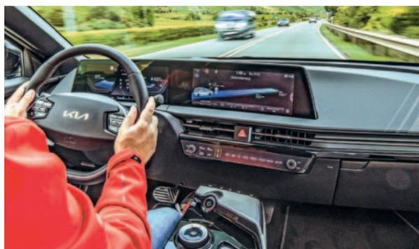
Die Kommandozone besteht aus einem laaangen Breitband-Kino mit Touchdisplay in der Fahrzeugmitte sowie Kurzwahl-tasten und Lautstärke-regler darunter.
